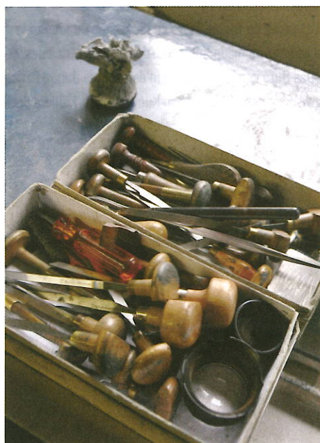
Eine Werkzeugkiste des Meisters: Stichel, Nadel, Schaber und Lupen, um auch jeden kleinsten Fehler sofort erkennen zu können Fotos: © Isabella Marboe
